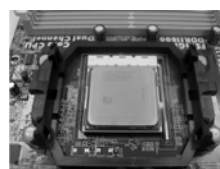
FASE 4: Abbassare e bloccare la levetta socket
