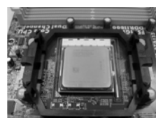
步骤 4： 下推并锁住插座拉杆
